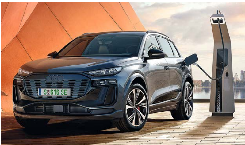
800-Volt-Technik und eine maximale DC-Ladeleistung von 270 kW bei Schnellladesäulen
