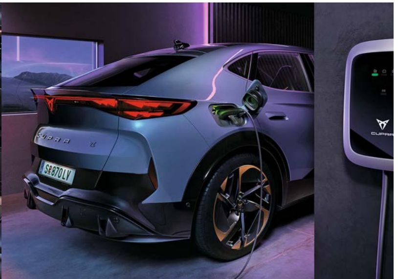
Die Lithium-Ionen-Batterie mit einer Nettokapazität von 77 kWh ermöglicht Reichweiten von bis zu 550 Kilometern und kann an einer 135-kW-Ladestation in weniger als 30 Minuten auf 80 Prozent aufgeladen werden.
